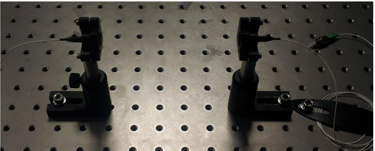
Εικόνα 6-3. Ασύρματη ζεύξη μεταξύ δύο δίοπτρων με φακούς βαθμωτού δείκτη διάθλασης (GRIN lens) σε απόσταση 15cm κατά προσέγγιση.
