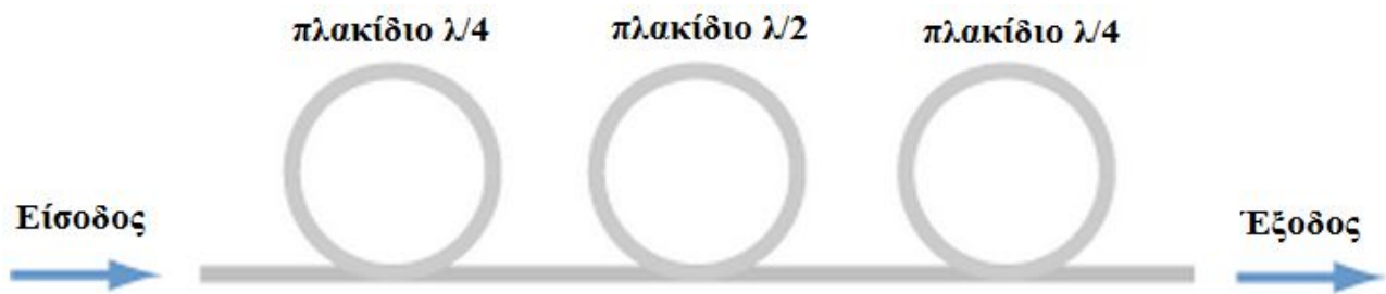
Εικόνα 5-10. Σχηματική αναπαράσταση της αρχής λειτουργίας ενός ελεγκτή πόλωσης.
