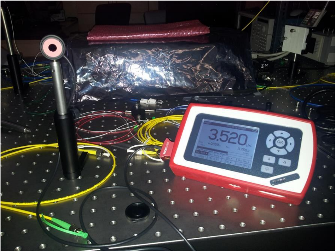
Εικόνα 4-10. Δεξιά ο μετρητής PM100D και αριστερά ο φωτοδέκτης S122C. Ο συνδυασμός των δύο οπτικών διατάξεων βοηθά στην καταμέτρηση οπτικής ισχύος στον ελεύθερο χώρο.
