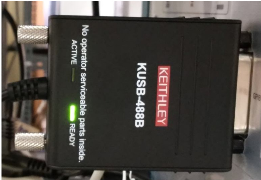
Εικόνα 8-3. Ο GPIB ελεγκτής που μας δίνει USB έξοδο για να συνδέσουμε τον εξοπλισμό με τον Η/Υ
