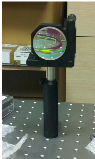
Εικόνα 7-1. Καθρέπτης διαμέτρου 4cm, ο οποίος χρησιμοποιήθηκε για την οδήγηση της οπτικής δέσμης από την διόπτρα τριπλού φακού στην οπτική πύλη σε πειράματα όπου οι δύο free-space διατάξεις δεν ήταν ευθυγραμμισμένες.
